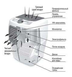
Устройство предназначено для очистки и увлажнения воздуха в офисах, жилых и рабочих помещениях.
