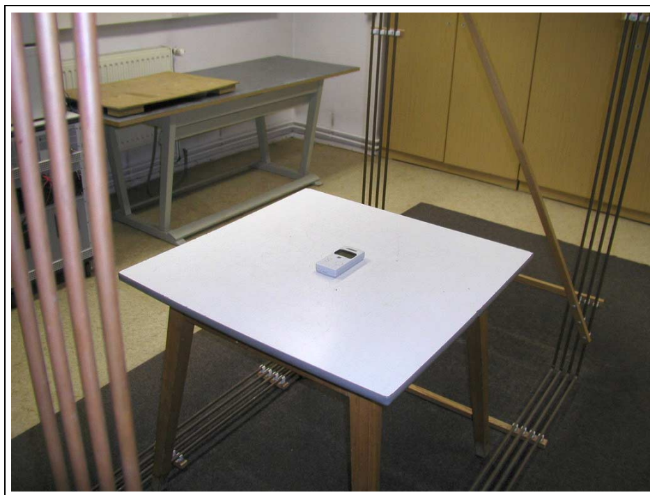
Bild 4 : Prüfanordnung "Störfestigkeit gegen Magnetfelder mit energietechnischer Frequenz"
