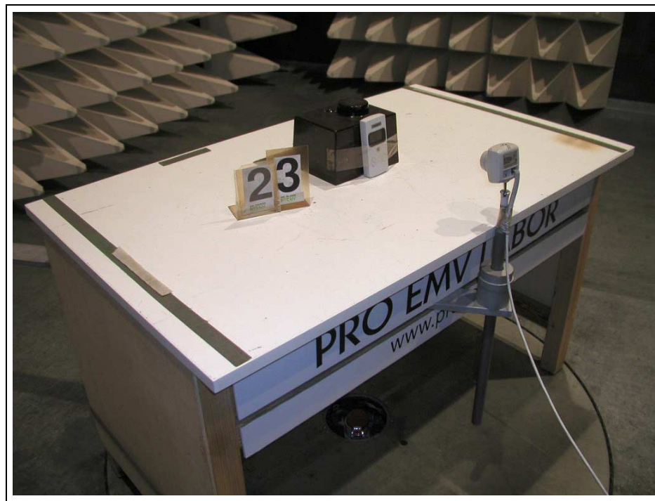
Bild 1 : Prüfanordnung "Funkstörfeldstärkemessung", "Störfestigkeit gegen elektromagnetische Felder"
