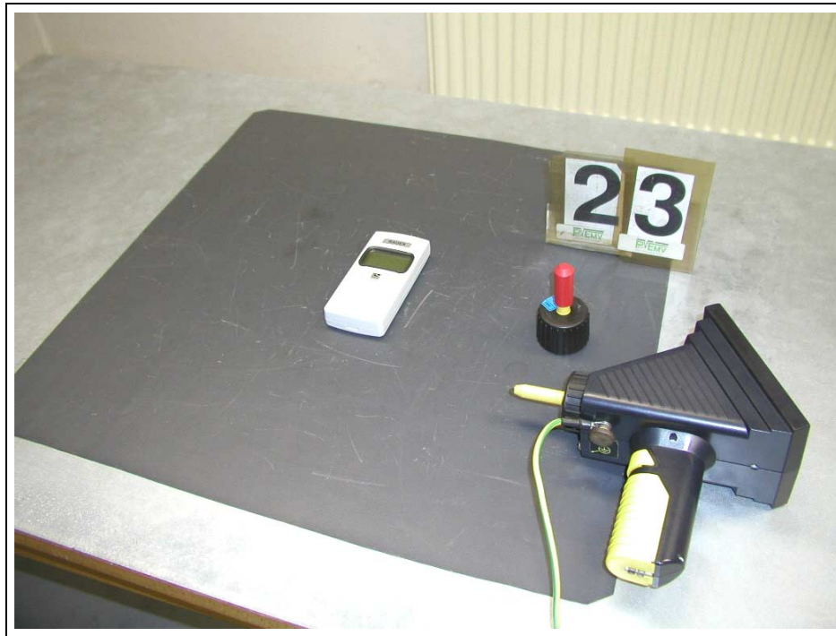
Bild 3 : Prüfanordnung "Störfestigkeit gegen elektrostatische Entladungen (ESD)"
