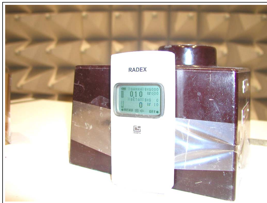
Bild 2 : Prüfanordnung "Funkstörfeldstärkemessung", "Störfestigkeit gegen elektromagnetische Felder"
