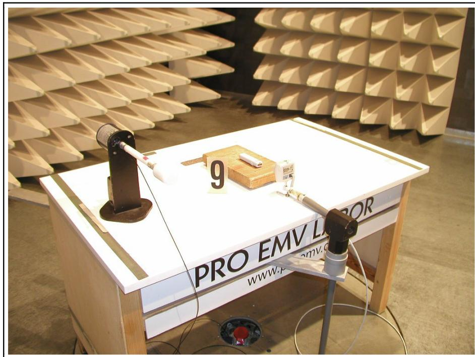
Bild 1 : Prüfanordnung "Funkstörfeldstärkemessung", "Störfestigkeit gegen elektromagnetische Felder"
