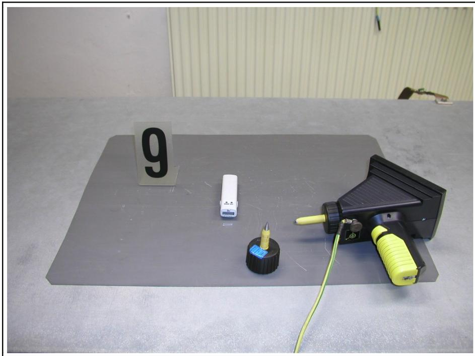
Bild 3: Prüfanordnung "Störfestigkeit gegen elektrostatische Entladungen (ESD)"
